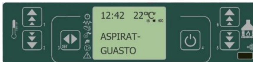
Фигура 7.7. Алармено съобщение при повреда на вентилатора на димните газове.
