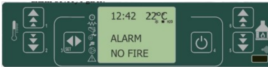
Фигура 7.3. Алармено съобщение при невъзможност за запалване.
