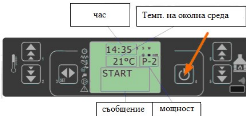
Фигура 5.1. Стартиране на работата на пелетната камина.
