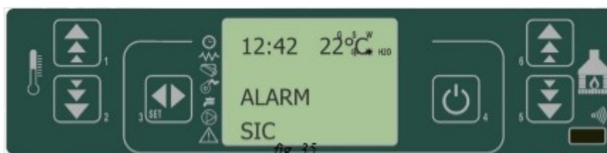
Фигура 7.6. Алармено съобщение при прегряване на камината.
