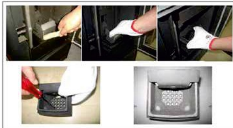
Фигура 6.4. Почистване на горивната скара и горивната камера.
