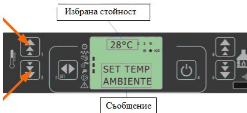
Фигура 5.2. Промяна на настройката на околната температура.
