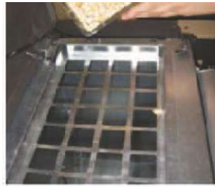
Фигура 8.1. Запълване на бункера с дървесни пелети.
